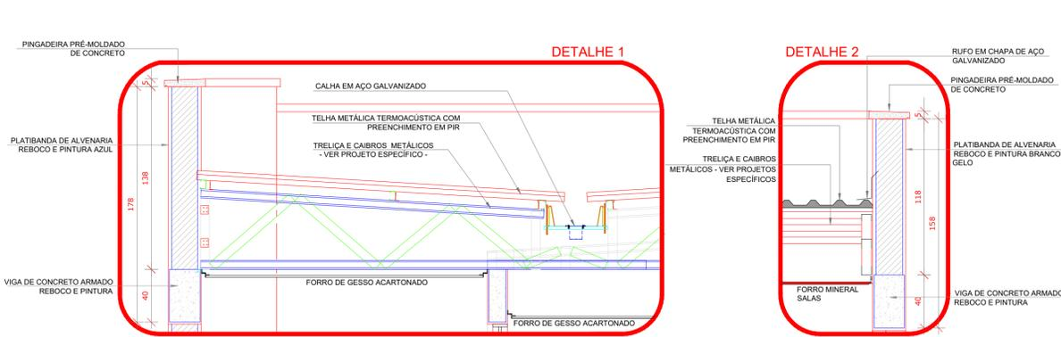
4 AMPLIAÇÃO DAS PLATIBANDAS, RUFOS E CALHA
